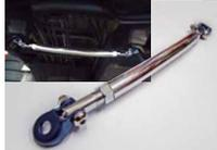
車両中央部の左右を繋ぐことでネジレを抑制し剛性を高めます。
